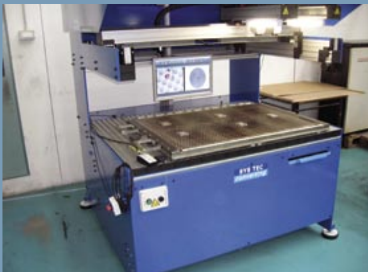
L'innovativo montacliché brevettato da Sys Tec Converting che risolve i problemi di messa a registro e di tempi di avviamento per la stampa a caldo
