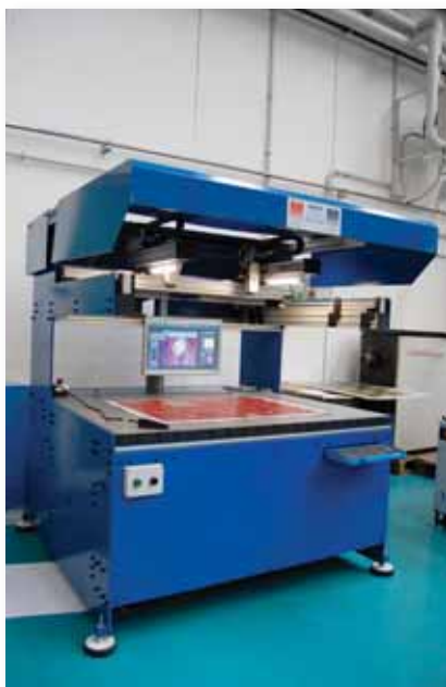
Gold, l'unica macchina montaclichè destinata al mondo offset. Grazie a questa macchina è possibile posizionare correttamente i clichè sulla piastra a nido d'ape / Gold is the only plate assembling machine for the offset sector. It enables you to position the plate on the honeycomb stereotypes
